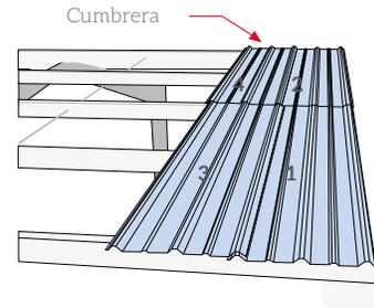
**3. Medición y corte de las tejas:** Mida la distancia entre las correas de la estructura y corte las tejas de PVC a la longitud adecuada. Asegúrese de que los posibles traslapos coincidan con un elemento de apoyo, así mismo, asegúrese de dejar un espacio entre la zona perimetral del área a cubrir y los elementos estructurales adyacentes, de manera que permita la expansión y contracción de las tejas.
